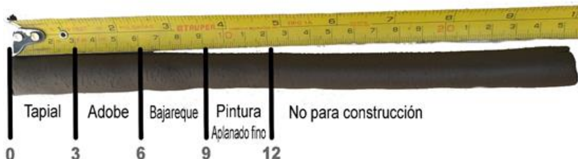
Figura 5. Aplicación de la tierra según el corte del churro. Fuente: Elaboración propia (2018).
